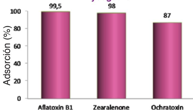
Condiciones del ensayo: pH 6.5 at 37 °C durante 2 horas.
